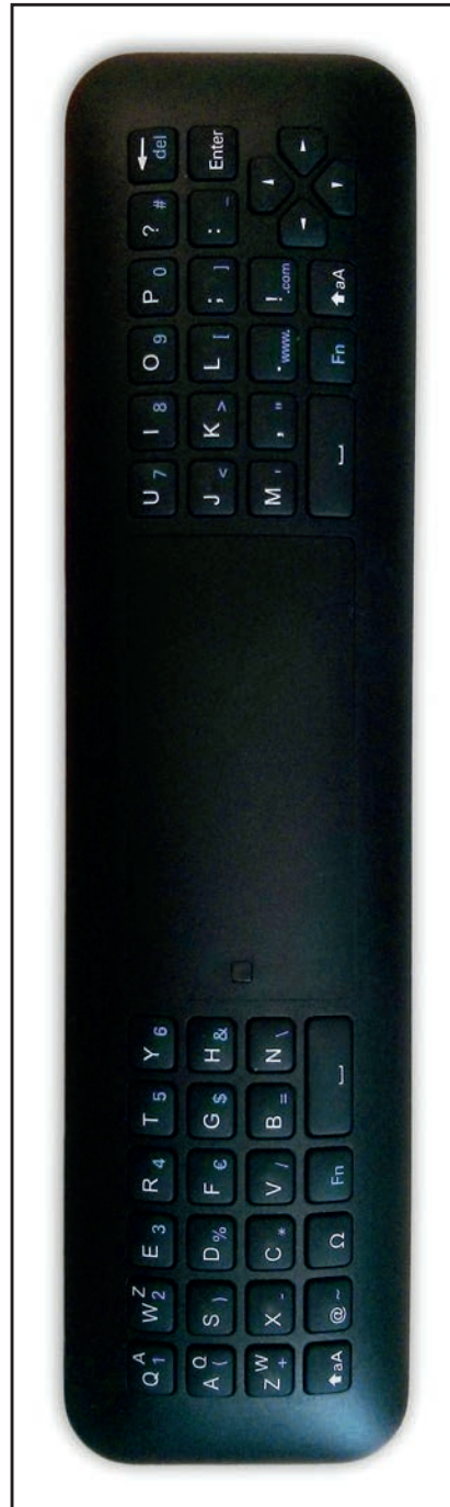
Abbildung 3.4: Fernbedienung mit Rückseitentastatur
