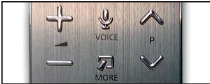
Abbildung 3.2: Gut ertastbare Ton- & Programmwippe
