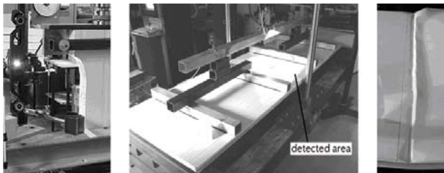
Versuchsbaufbau mit Streifenprojektionsscanner GOM ATOS II und kleinem Bauteil (links); sechs-Punkt Biegeversuch mit Lasteinleitung in den Bauteilviertelpunkt. In der Mitte das Messfeld des Scanners (Mitte); Sandwichpaneel nach dem Versagen (rechts).
