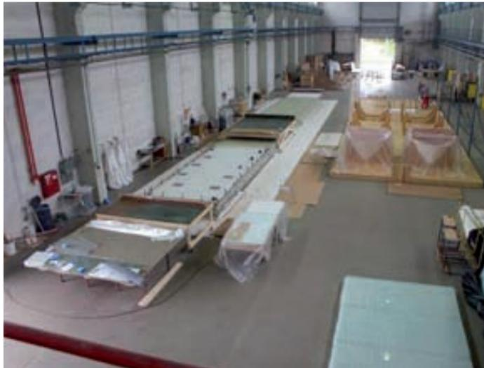
Herstellung von glasfaserverstärktem Kunststoff, der traditionell vor allem in der Luftfahrt verwendet wird
