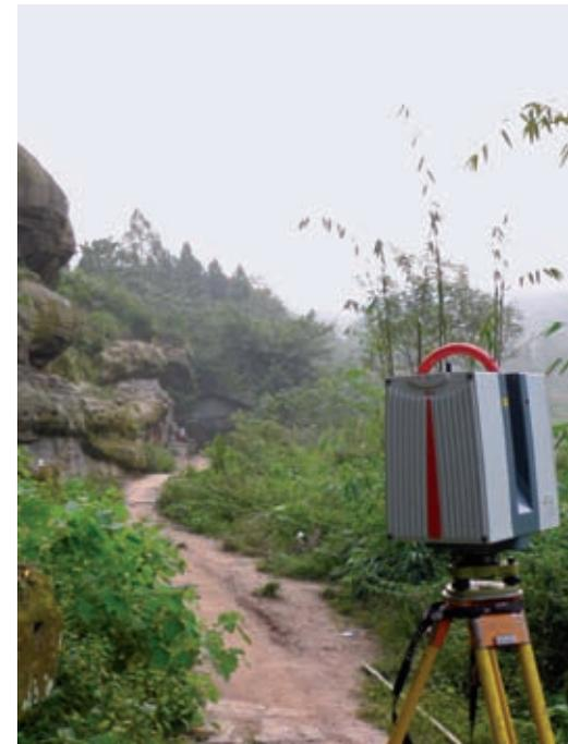
Terrestrischer 3D-Laserscanner HDS 6000 zur Erfassung der Höhlen-Topographie
