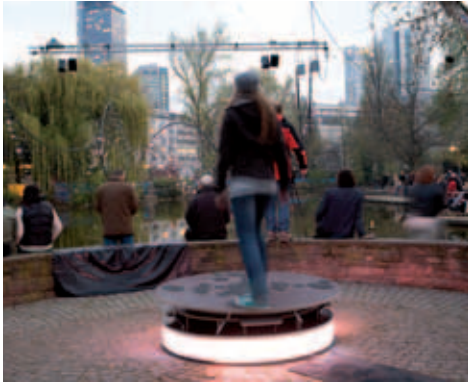
Die Interaktionsplattform, die 1600 LED-Leuchten steuert
