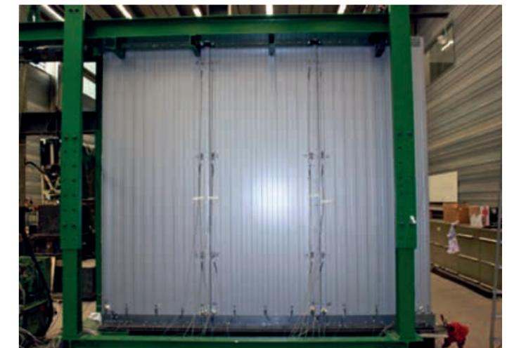
Abb. 2: Versuchsstand Wandscheibentragfähigkeit
