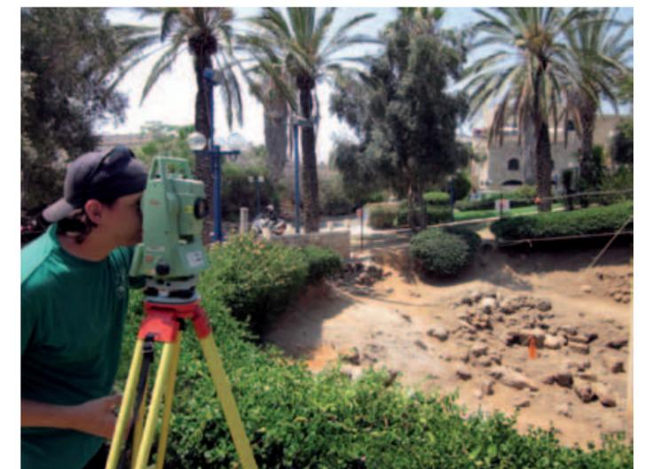
Konzentration bei der Vermessung mit der Totalstation
