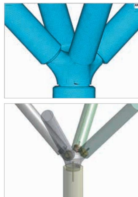
Abb. 4: Komplexer 3D-Knotenpunkt in Holz-Beton-Verbundbauweise
