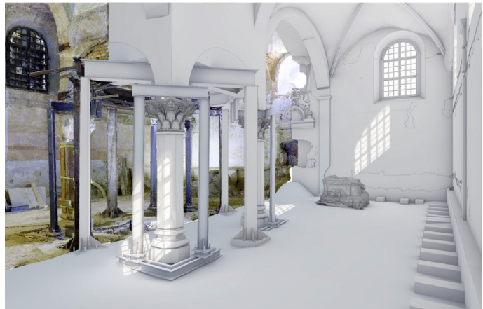
Abb. 2: Längsschnitt durch das 3D-Modell der Synagoge in Przysucha, im Vordergrund LOIN 500, im Hintergrund Rohdaten der Punktwolke (AI MAINZ/Karol Argasiński, 2022)
