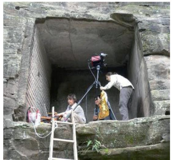
*Erfassung der Sutren mittels eines Streifenlichtscanners*
