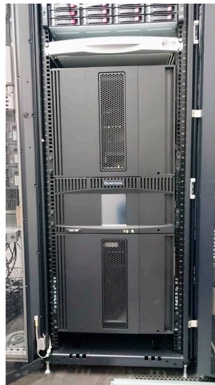
Abb. 2: Schicht 2 – IBM Tivoli System für Backup und Archivierung der Forschungsdaten des i3mainz
