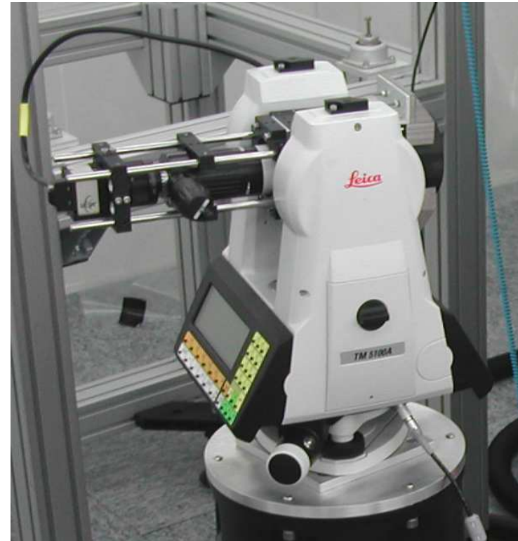
i3mainz-Digitalkameratheodolit auf Basis des Autokollimationstheodolits Leica TM5100A
