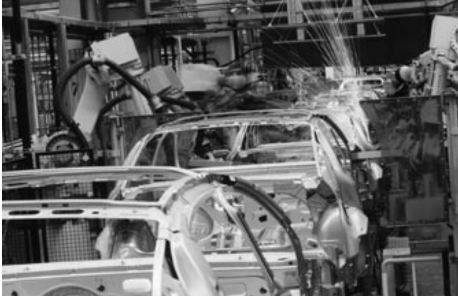
Automatisiert greifen, schweißen und messen unzählige Roboterarme die vorgefertigten Karosserieteile
