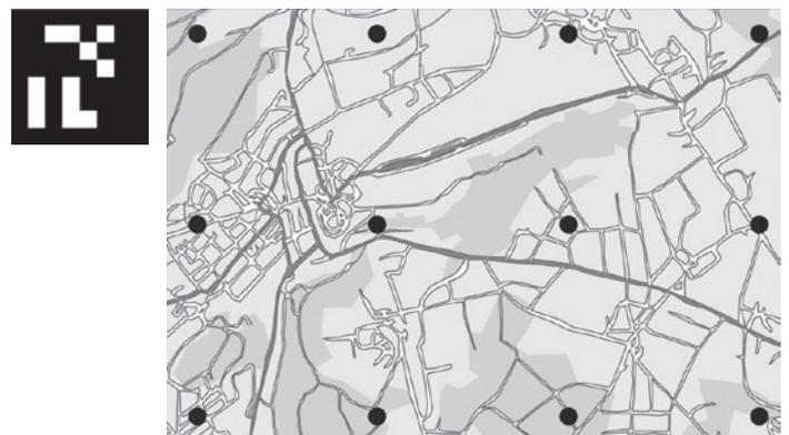
Abb. 2: Beispiele für markerbasierte Tracker (ID Marker vs. DOT Marker)
