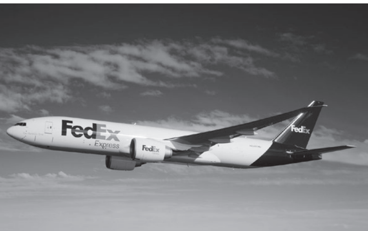
FedEx Boeing B777F: Im Vergleich zur MD-11, die sonst auf Langstrecken eingesetzt wird, kann das Flugzeug knapp sieben Tonnen mehr Fracht transportieren und fast 3.900 Kilometer weiter fliegen – und das bei geringerem Treibstoffverbrauch. Die B777F stößt darüber hinaus 18 Prozent weniger CO 2 -Emissionen aus und ist wesentlich leiser.
